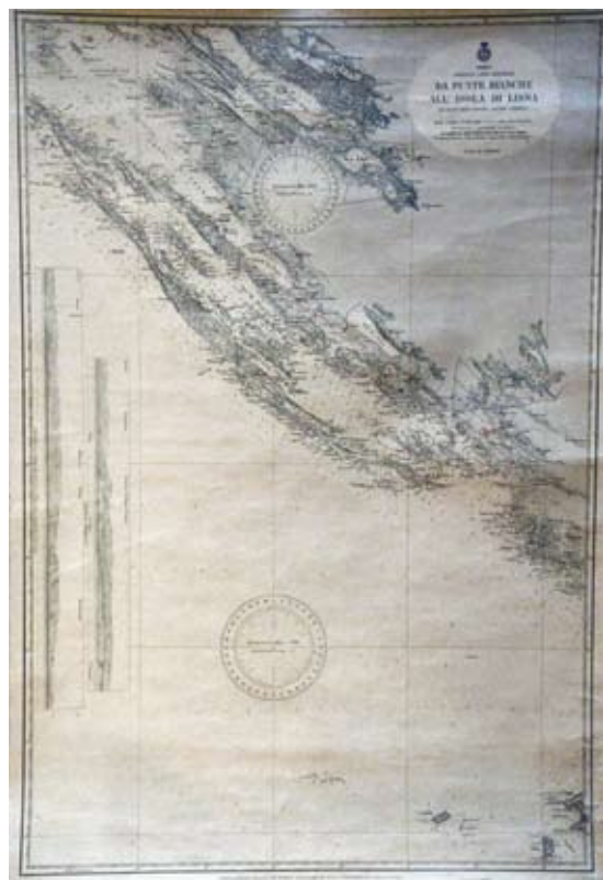
874 Istituto idrografico: Jadranska obala od Dugog otoka do Visa i Biševa. Nautički zemljovid otoka i priobalja s mjerama dubine mora. Na rubu zemljovida skice dva horizontalna presjeka kopna gledano s Dugog otoka. Vrlo detaljan zemljovid velikih dimenzija, 93x63 cm, Genova 1930.
